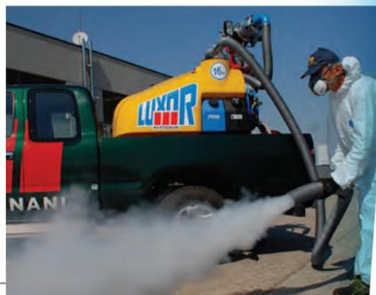
4. **Kit Termonebulizador** para el sistema de pulverización, incluye: termonebulizador, cable de conexión, etc.
