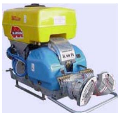
400 l con difusor a 2 sectores 90°+90° con dispositivo electrostático
