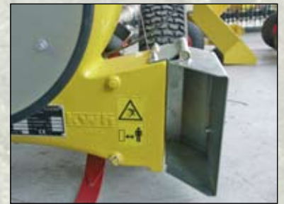
Deflettore aria orientato verso il basso per soffiatura in avanti
