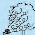
4. Forte turbolenza nel flusso d'aria, da cui deriva grande perdita di velocità e di potenza.
